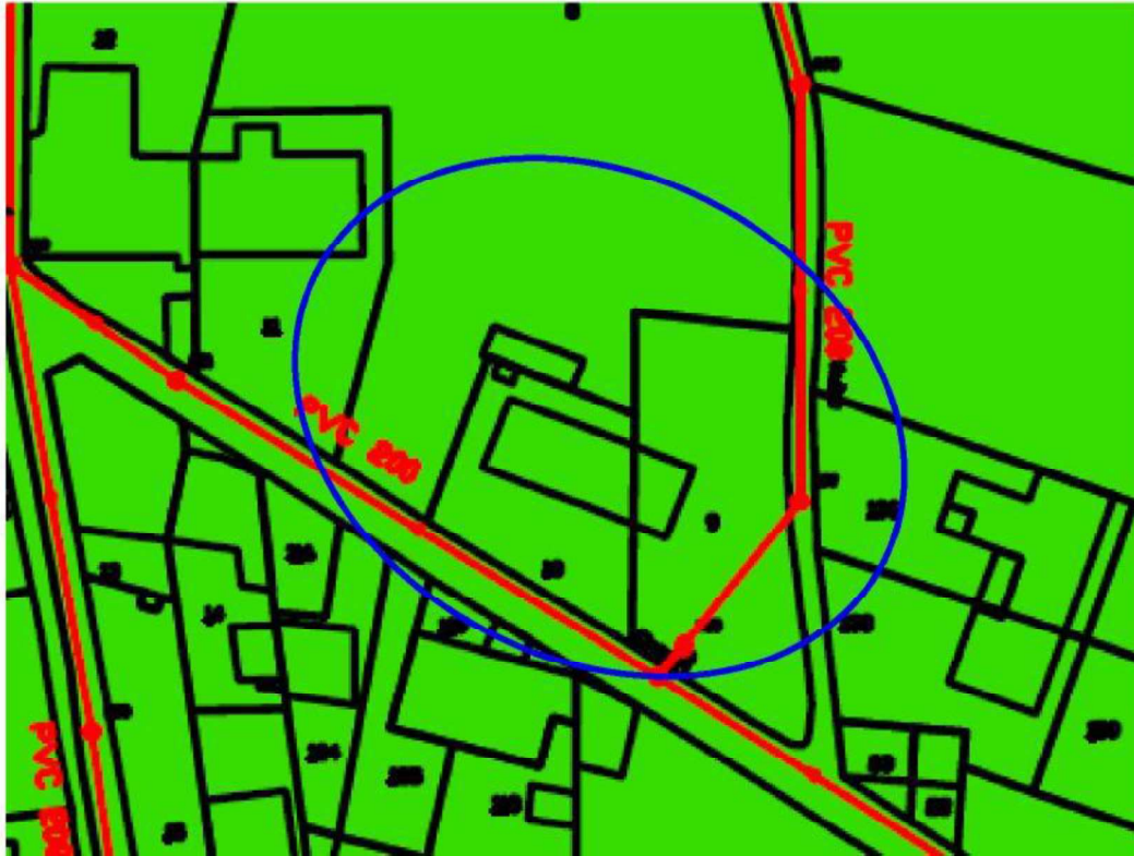
Extrait plan de réseau (en rouge) et zonage d'assainissement (collectif en vert)
